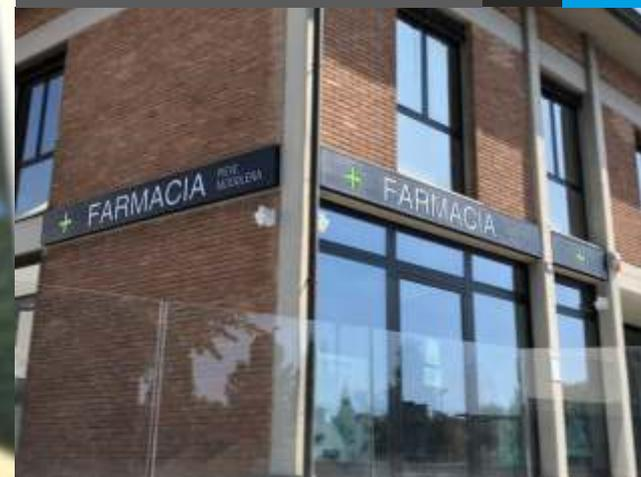
Insegne luminose composte da struttura scatolare interamente in alluminio, traforato e verniciato con smalto personalizzato ad effetto texturizzato e materico. La retroilluminazione è del tipo a led a luce fredda 6500 K° per una visibilità notturna di elevato impatto.
